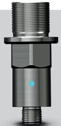
Der optische Füllstandsensor CALIS von CAPTRON basiert auf der ToF-Technologie. Es ist keine Kalibrierung aufs Medium nötig, da sich die Medieneigenschaften nicht auf die Messung auswirken. Zudem wird der Füllstand kontinuierlich gemessen und kann
