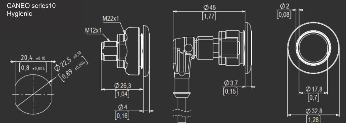
Alle Maßangaben in mm. Imperiale Maße in eckigen Klammern. Anschlusskabel M12 als Zubehör erhältlich.
